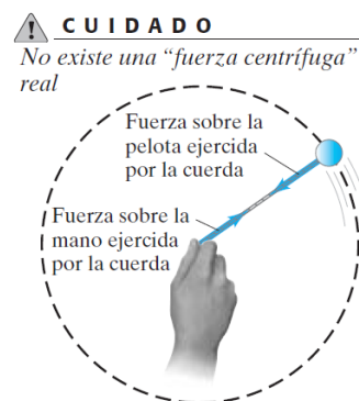
Fig. 9: Movimiento circular de una pelota atada a una cuerda
